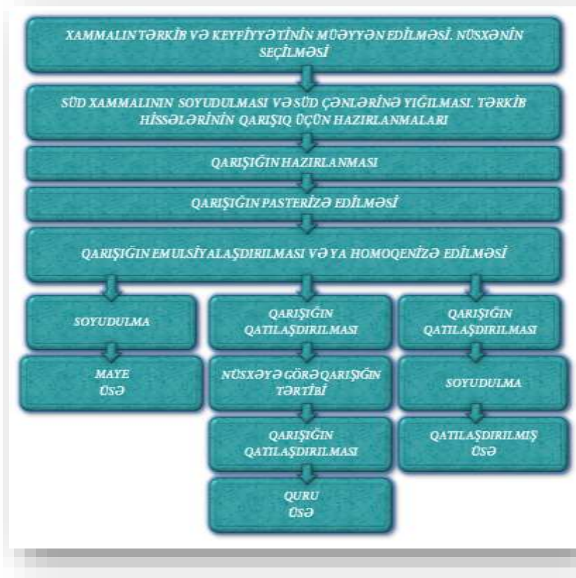
Şəkil 2. Üzlü süd əvəzedicilərin istehsal sxemi
