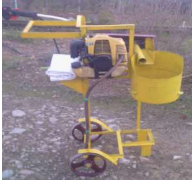
Şəkil 3. Yaşıl tut yarpağını budaqlardan təmizləyən təcrübi səyyar qurğunun ümümi görünüşü.
